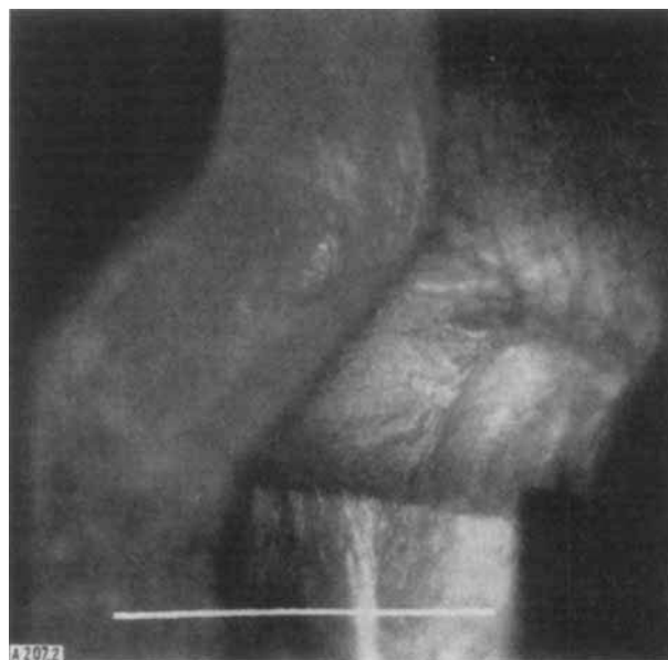
Abb. 2. Knickband in Nylon 6.10. Länge des weißen Striches: 1 mm
